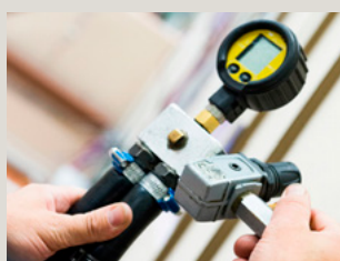
GASSYSTEEM Het flessengassysteem wordt onder druk getest.
