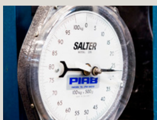
TREKINRICHTING Meetinstrument voor de trekrichting.
